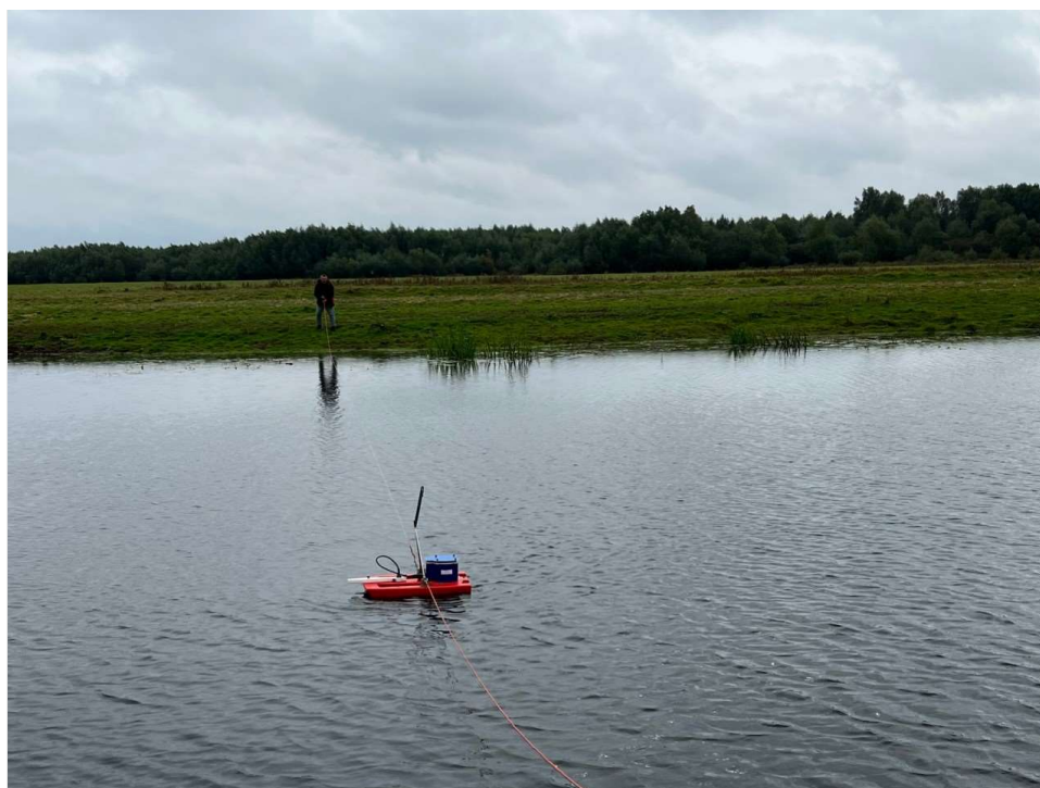
Fot. 33 Pomiary hydrometryczne na rzece Postonii z wykorzystaniem prądomierza ADCP.
