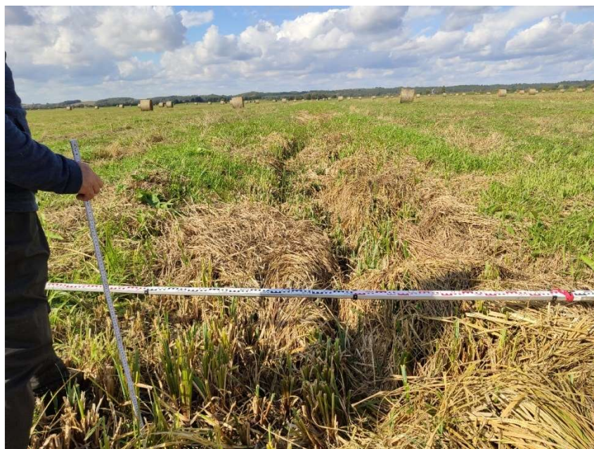
Fot. 16 Realizacja pomiarów inwentaryzacji terenowej - przykład rowu zanikającego.
